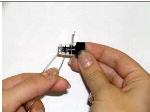
4. Продеть тросик через проушины или отверстия на пломбируемом объекте, после чего продеть насквозь второй конец тросика через правое отверстие корпуса пломбы и сердечника.
