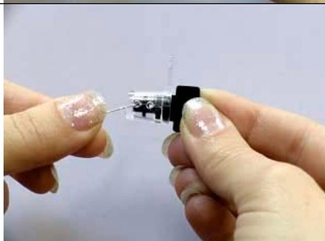
3. Вставить конец тросика в левое отверстие корпуса пломбы и сердечника до упора. Сделать два оборота флажка по часовой стрелке, чтобы тросик намотался на сердечник.
